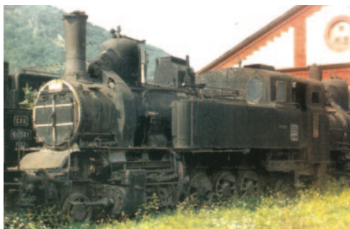
Fig. 7: C.p.i. - Locomotiva CFR 40.007 D, tip 1D1-n2(4)zz, construită de Wiener Lokomotivfabriks - A.g. Florisdorf (1908) pt. linia cu cremalieră Subcetate - Boușari; viteza maximă 40 km / oră, iar pe linia cremalieră (sistem ABT) 12 km / h. Remiza Subcetate 1988, editată de Gruparea Filateliceă Feroviară Reg. CFR Timișoara, necirculată
