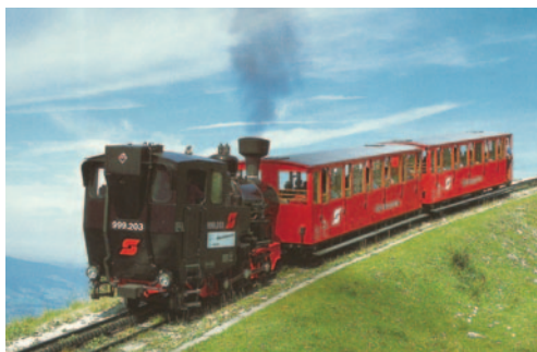
Fig. 9: C.p.i. - Schafbergbahn Dampf - Zahnradlokomotive 999.203 (prescurtat și tradus de autor - ecartament 1.000 mm, sistem Abt, fabricată cu nr. 5687 în 1996 la firma SLM din Wintenthur), editor firma „REIJU”, nedată, necirculată
